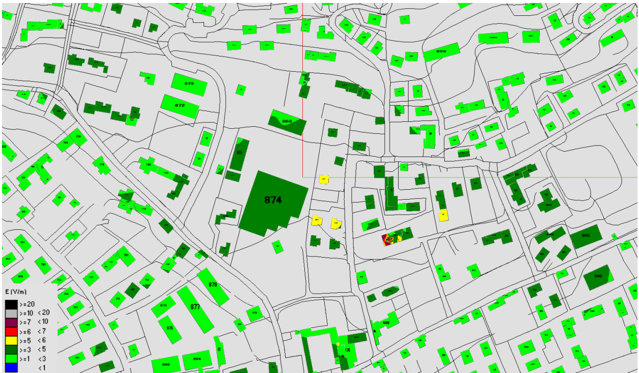
Fig. 13 Impatto elettromagnetico – Zona Via del Soccorso e Via G. Macarro – Vista dall'alto
